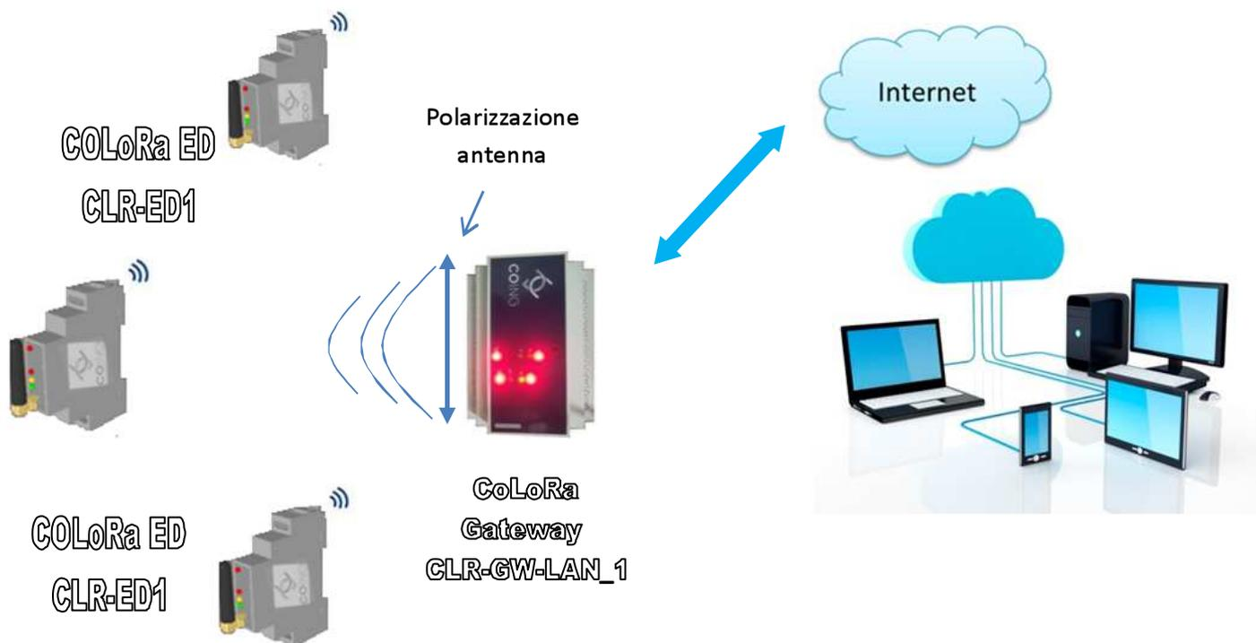
Il dispositivo si presta per applicazione indoor con disponibilità della rete elettrica e della connessione LAN. L'antenna integrata, polarizzata lungo il lato maggiore della box, è stata ottimizzata per aumentare il raggio di copertura .
