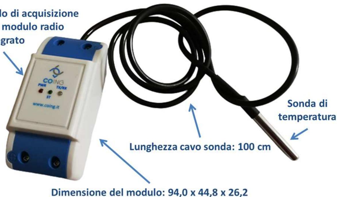
Il nodo rileva e invia i dati di temperatura con frequenze temporali configurabili (tempo impostato da fabbrica ogni 30 minuti).
